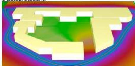
Le principe des cours intérieures est un de ceux qui permettent le mieux de dégager des espaces calmes (zone blanche), protégés du bruit de la circulation. La forme et la dimension de ces cours ne peuvent être laissées au hasard, de même que le traitement de la façade exposée.
